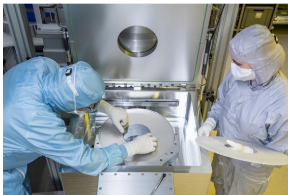
Forschende bereiten den Diamanten für den Ätzprozess vor. © Fraunhofer IOF
